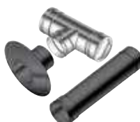
Raccordo unico con rosone dn esterno 220 mm telescopico dn 100 ridotto a dn 80 con kit magnetici
