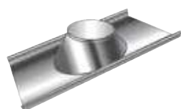
Faldale regolabile 5°/30° con base in piombo
